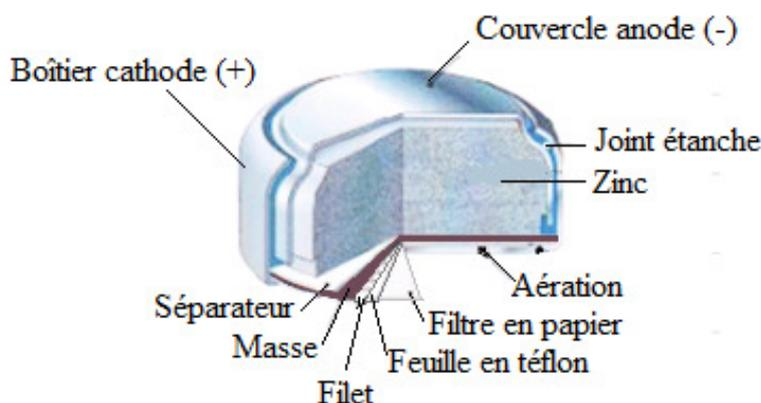
Figure 6 : Composants d'une pile zinc-air [11]
