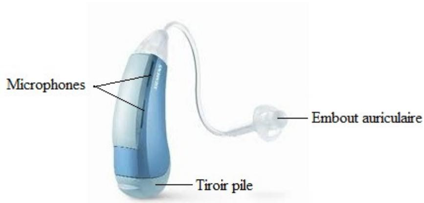
Figure 2 : Emplacement de quelques éléments d'un contour d'oreille [18]
