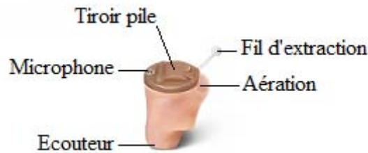
Figure 4 : Emplacement de quelques éléments d'un intra-auriculaire [25]
