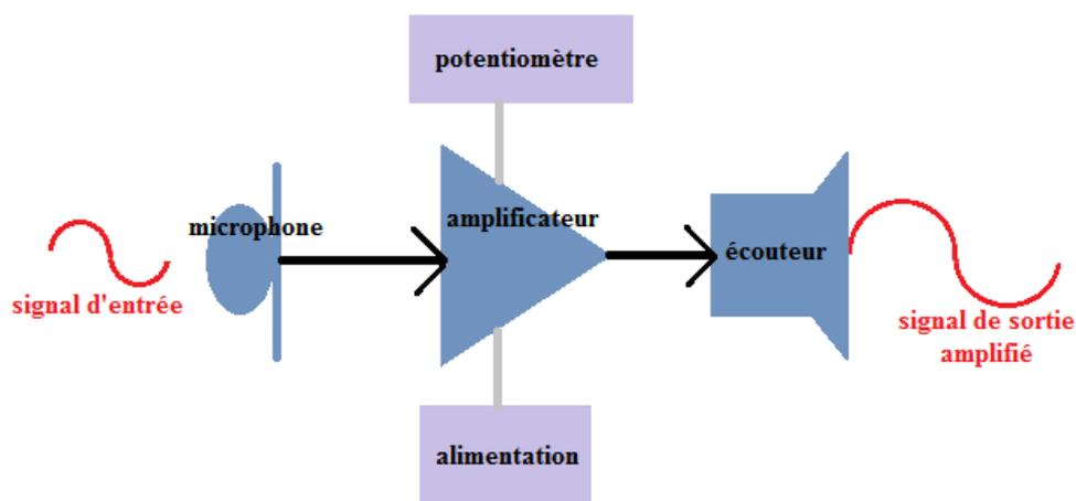
Figure 1 : Schéma des principaux composants d'une aide auditive [14]
