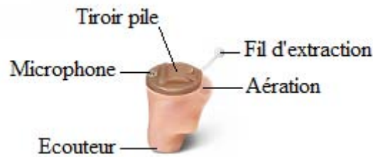
Figure 4 : Emplacement de quelques éléments d'un intra-auriculaire [25]
