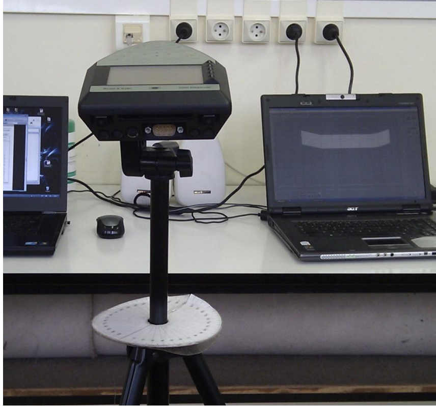
Figure 17 : Positionnement du sonomètre afin d'être à l'emplacement de la tête du sujet testé
