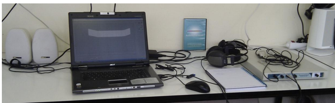
Figure 15 : Installation du matériel avec de gauche à droite : les haut-parleurs, l'ordinateur équipé du logiciel, le module externe du Visible Speech
