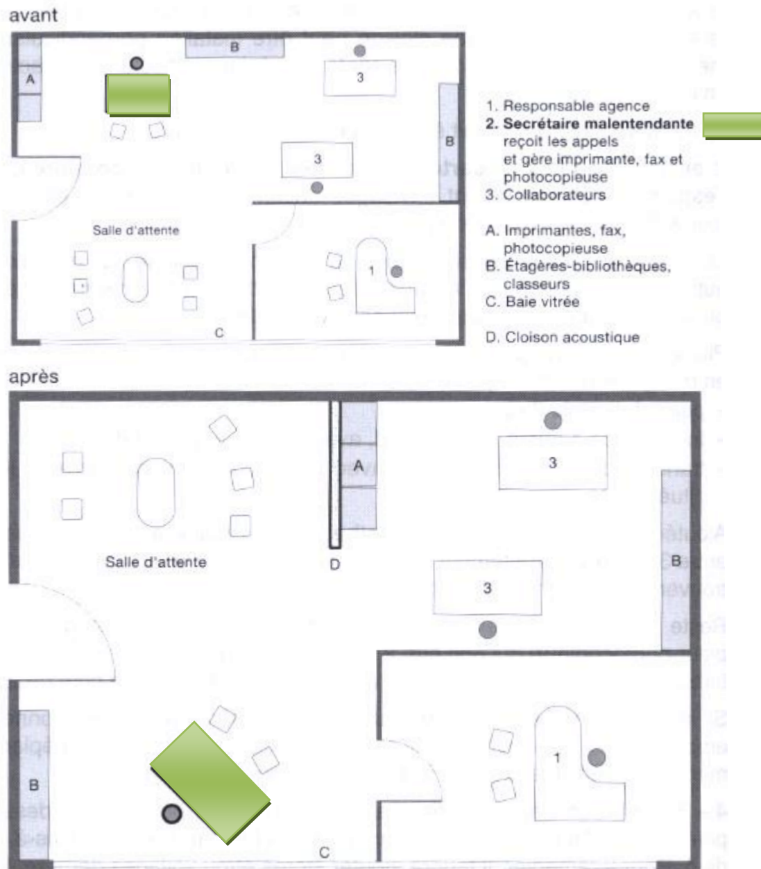
Figure 10 : Aménagement de poste n°2. [16, p. 152]
