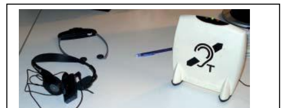
Figure 13 : Boucle magnétique portable. [25]
