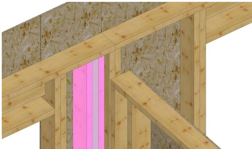
*Figure 19: Liaison entre mur de refend et mur extérieur (montants supplémentaires en rose)*
