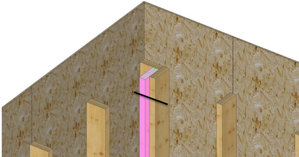
Figure 16: Angle sortant à 90° (montant supplémentaire en rose)
