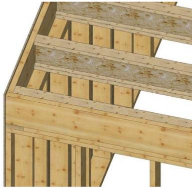
Figure 20 : Liaison mur plancher
