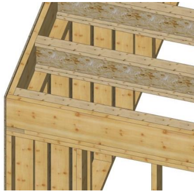
Figure 20 : Liaison mur plancher
