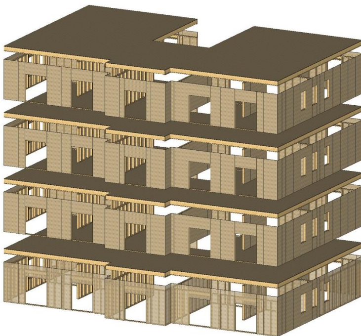
Figure 12 : Représentations de la structure en plateforme
