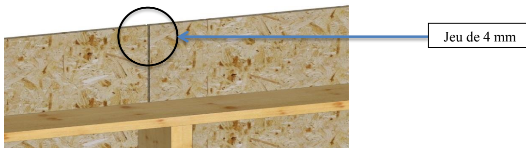
Figure 8 : Jeu entre panneaux d'OSB
