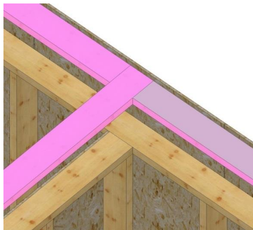
Figure 14: Mise en œuvre des lisses de chaînage (en rose)
