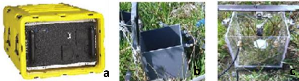
Figure 3: Matériel de mesure des flux : a=Analyseur de gaz (Los Gatos Research) b=Chambre en PVC c=Chambre claires
