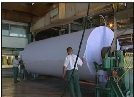
Les feuilles de papier sont produites à des vitesses de 2000 m/minute et subissent des contrôles permanents afin de garantir une qualité optimale. Il est à noter que la totalité des produits non conformes est intégralement recyclé. 90% de la production de la papèterie est destiné à l'usine de transformation
