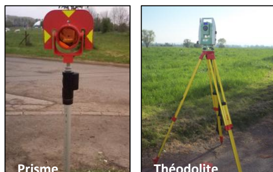
Photographie 3: Matériel utilisé lors des levés topographiques
