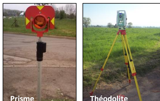
Photographie 3: Matériel utilisé lors des levés topographiques
