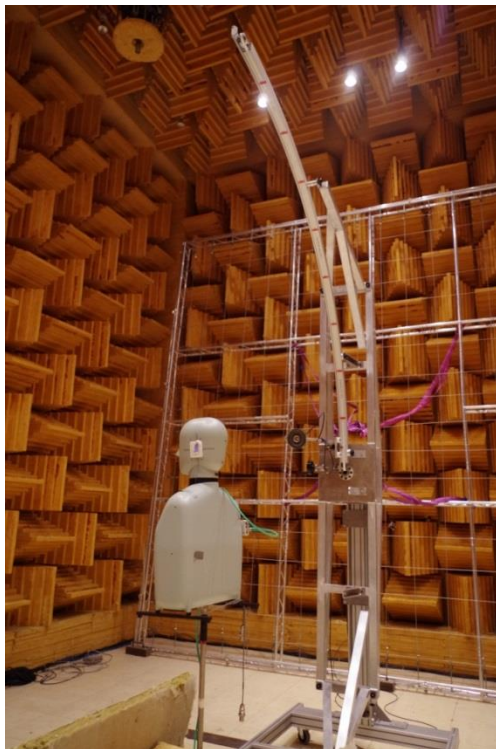
Figure 33 : « L'astrolabe » positionné dans le plan à 90°
