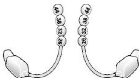
Figure 57 : Outils de mesure pour déterminer la taille du microphone pour le Lex
