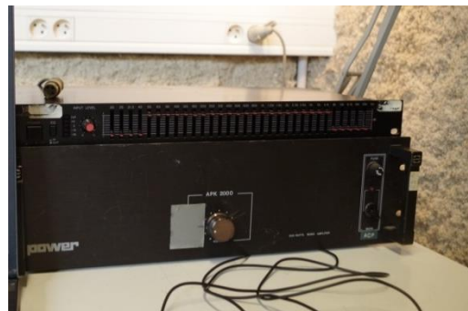
Figure 30 : Amplificateur branché en série entre le haut-parleur de diffusion et l'interface de branchement Net dB1
