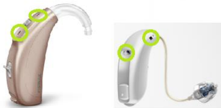
Figure 5 : Emplacement des deux microphones sur des appareils de type contours classiques et contours à écouteurs déportés [9 ; 10]
