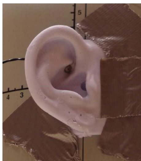
Figure 37 : Positionnement du microphone au niveau de la conque supérieure (ou cymba concha)
