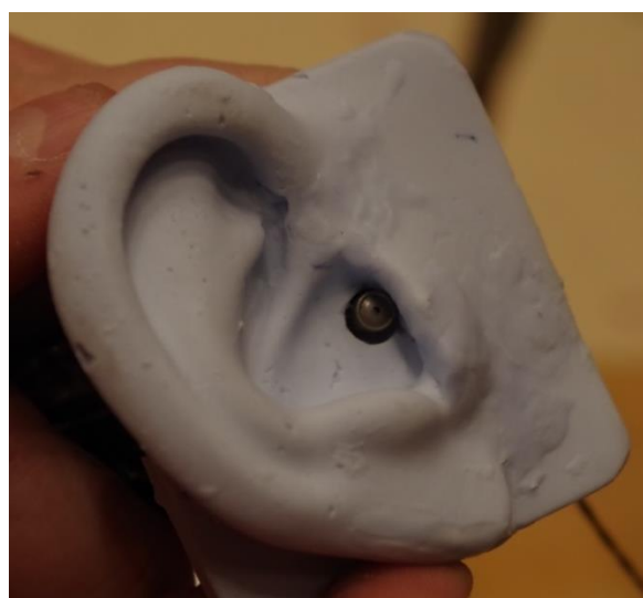
Figure 39 : Positionnement du microphone au niveau de l'entrée du conduit auditif
