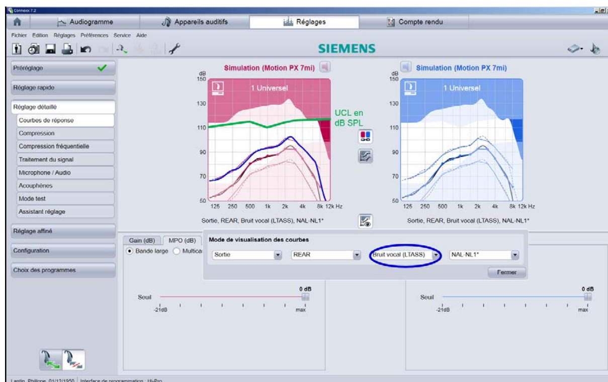
Illustration 31: Capture d'écran d'un réglage de MPO en prenant comme stimulus d'entrée le bruit vocal LTASS
