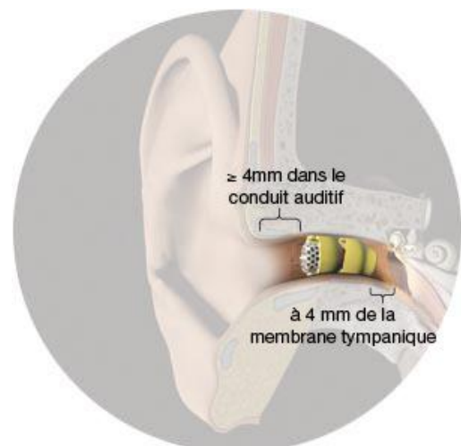
Figure 33- Placement du microphone et de l'écouteur (7)
