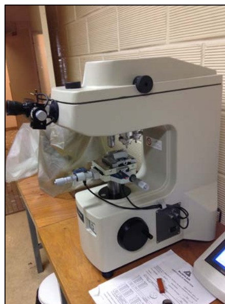
Figure 11 : Duromètre BUEHLER® Micromet 5104 de l'IJL de Vandoeuvre-lès-Nancy
