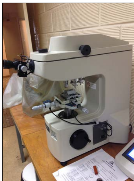
Figure 11 : Duromètre BUEHLER® Micromet 5104 de l'IJL de Vandoeuvre-lès-Nancy
