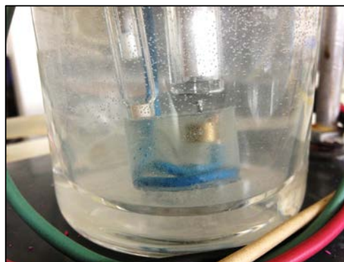
c) Electrode de travail, électrode de platine et contre électrode dans la cellule
