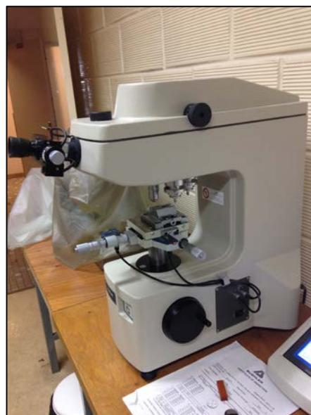
Figure 11 : Duromètre BUEHLER® Micromet 5104 de l'IJL de Vandoeuvre-lès-Nancy
