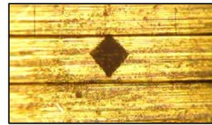
Figure 10 : Trace d'indentation Vickers dans la minivis RMO®
