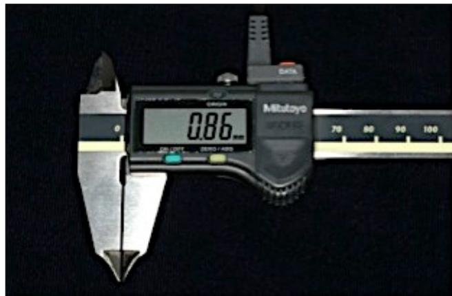
Figure 12 : Photo du pied à coulisse électronique Mitutoyo 500-161-20
