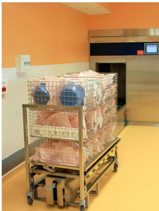
**Figure 17 : Sortie des caissettes après stérilisation, de l'autre côté du stérilisateur à deux portes**
