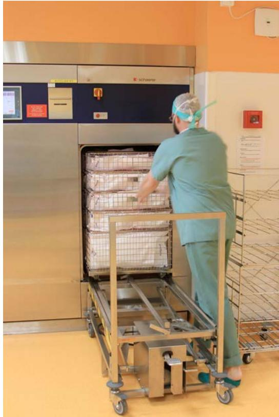
**Figure 16 : Insertion des caissettes dans l'autoclave (ECOSTAR, SCHAEFERMAYFIELD FRANCE GROUPE MMM)**
