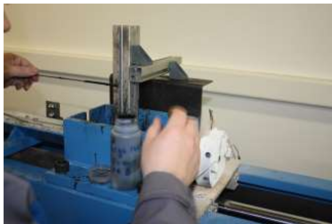
Figure 15 : Lubrification avant tréfilage
