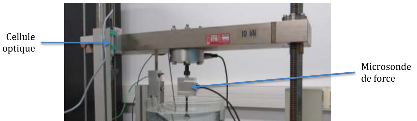
Figure 19 : Particularités de la machine de traction
