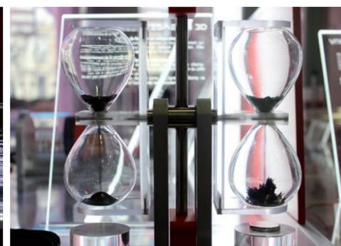
Le sablier magnétique. Dans le sablier de droite placé au-dessus d'un aimant, la poudre de fer s'aligne sur les lignes de champ.
