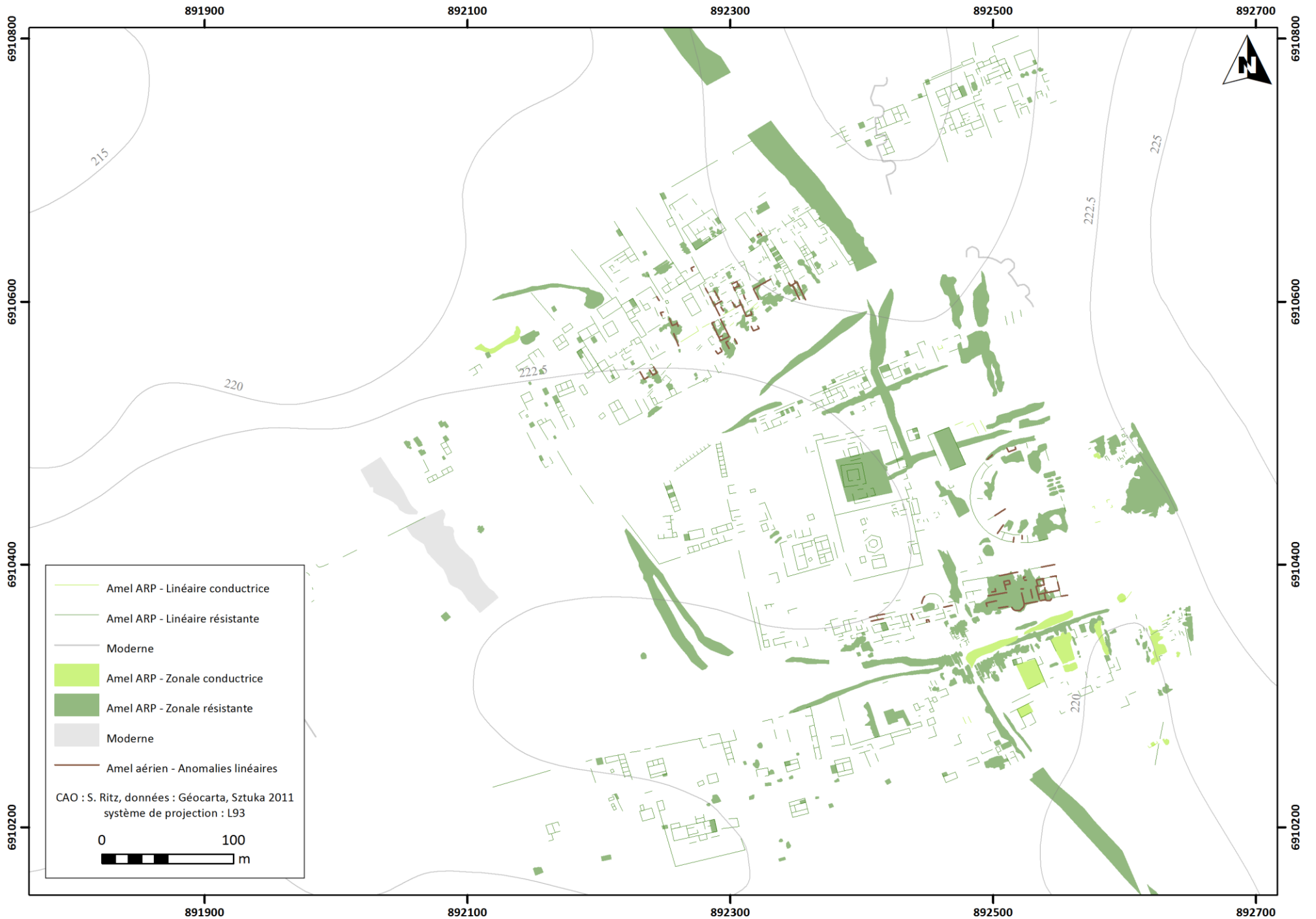
Figure 47 : carte d'interprétation technique des prospections électriques et aériennes réalisées à Amel-sur-l'Étang
