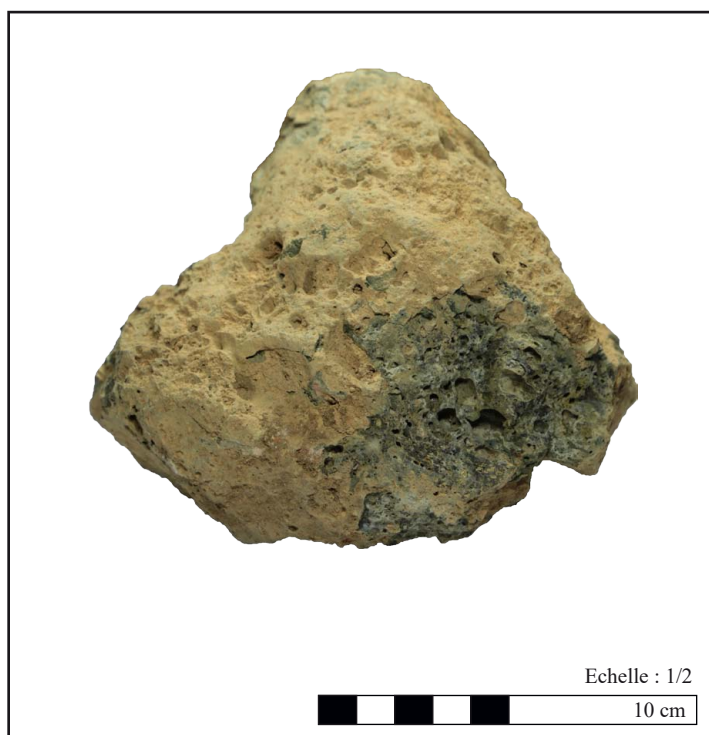
Figure 268 : scorie de réduction à structure bulbeuse (cliché : CARA, Maxence Pieters)
