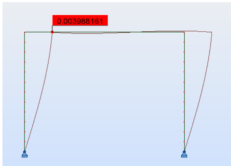
Figure 9 – Mode 1 de flambage de la structure
