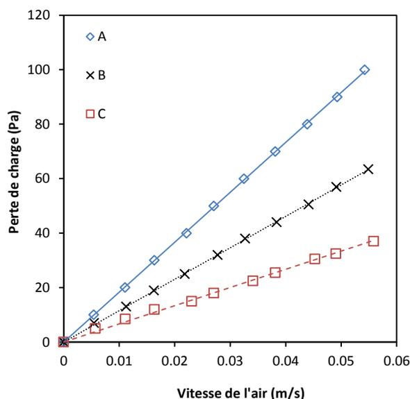
Figure 1. Evolution de la perte de charge des médias propres en fonction de la vitesse de l'air
