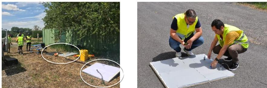
Figure 2. A gauche : les 2 ellipses blanches entourent les 3 cibles thermiques en polystyrène posées au sol (cible blanche, cible noire et cible grise) ; à droite : cible grise avec sonde *Tynitag*. Photographies prises lors de la mission drone du 8 juillet 2019 (Carré de l'Escadron, sur le Plateau de Frescaty).
