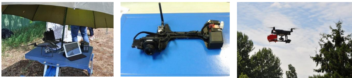
Figure 1. Dispositif d'acquisition d'images thermiques infrarouges. De gauche à droite : le drone, la tablette Ipad et les batteries ; la nacelle avec la caméra thermique ; le drone en vol avec la nacelle et la caméra thermique « sous abri ». Photographies prises lors de la mission drone du 8 juillet 2019 (Carré de l'Escadron, sur le Plateau de Frescaty).
