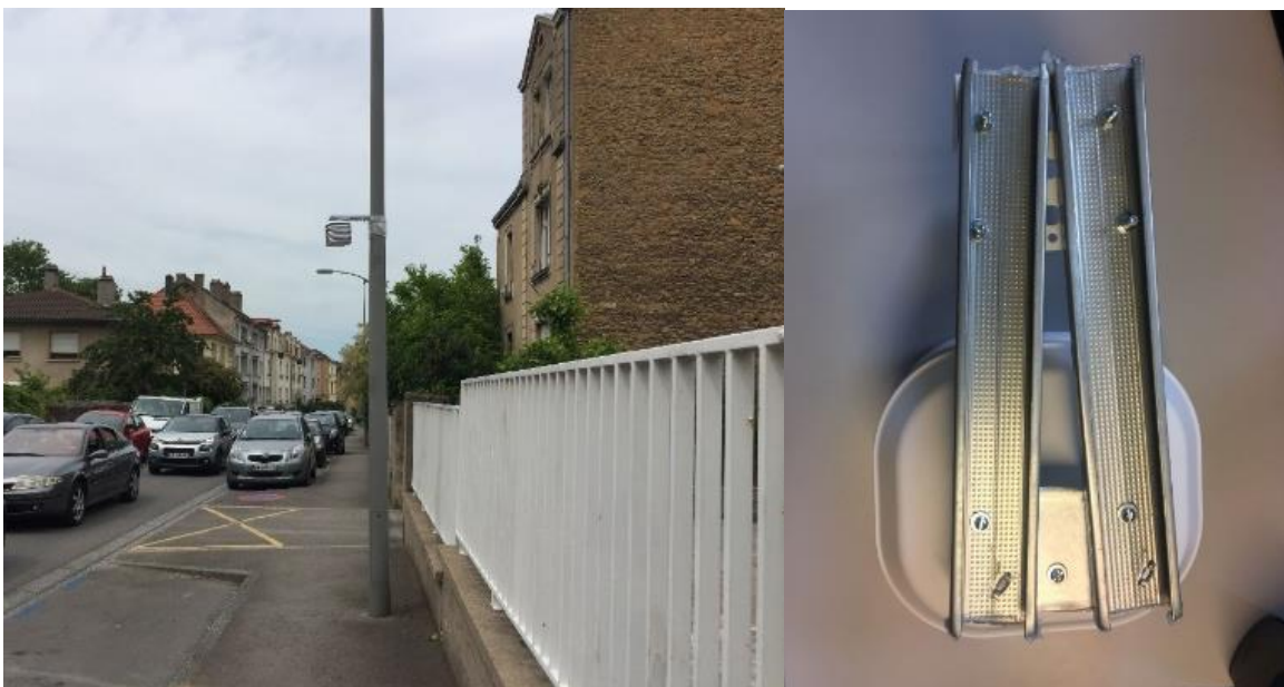
Figure 2 : a) Station météorologique du réseau REMTHAM (rue de Saint-Paul, Montigny-Lès-Metz, France). b) Système de fixation de l'abri météorologique.
