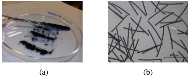
Figure 4. a) Fibres de textile teintées en polyamide. b) Image au microscope des fibres ( d = 18 \mu\text{m} , l = 500 \mu\text{m} ).
