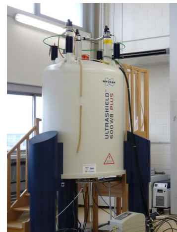
(b) Imageur à axe vertical. Fréquence de travail: 600 MHz.
