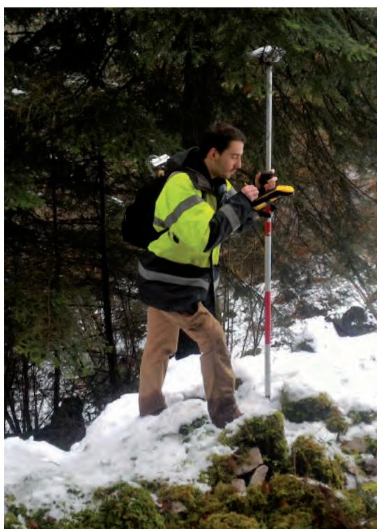
Figure 46 - Photographie d'un GPS GéoXH 3000 en cours d'utilisation
