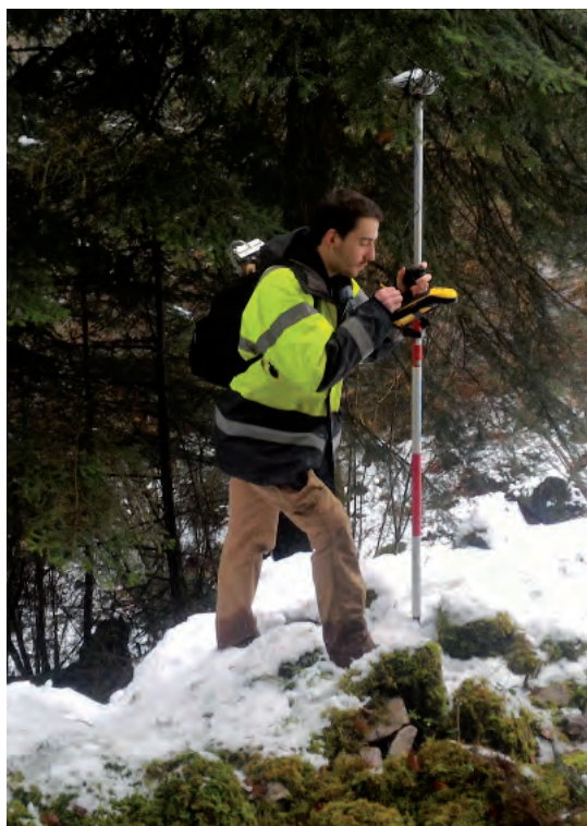
Figure 46 - Photographie d'un GPS GéoXH 3000 en cours d'utilisation
