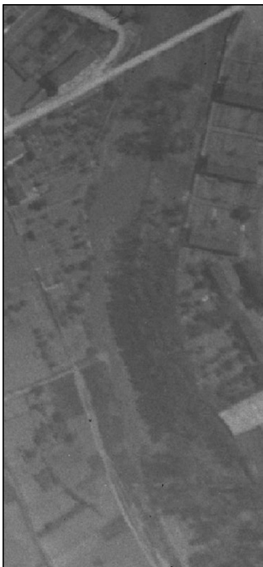
Figure 28 - Exemple de délimitation d'un cours d'eau rendu difficile du fait de la ripisylve présente qui apporte une ombre sur le cours d'eau, Rosselange (cliché 57-1955-0923-6911, IGN)
