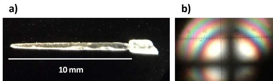
Figure 1 : a) Fibre monocristalline de \beta -BBO, b) Franges d'interférences de la fibre \beta -BBO observées sous conoscopie (analyse d'orientation).
