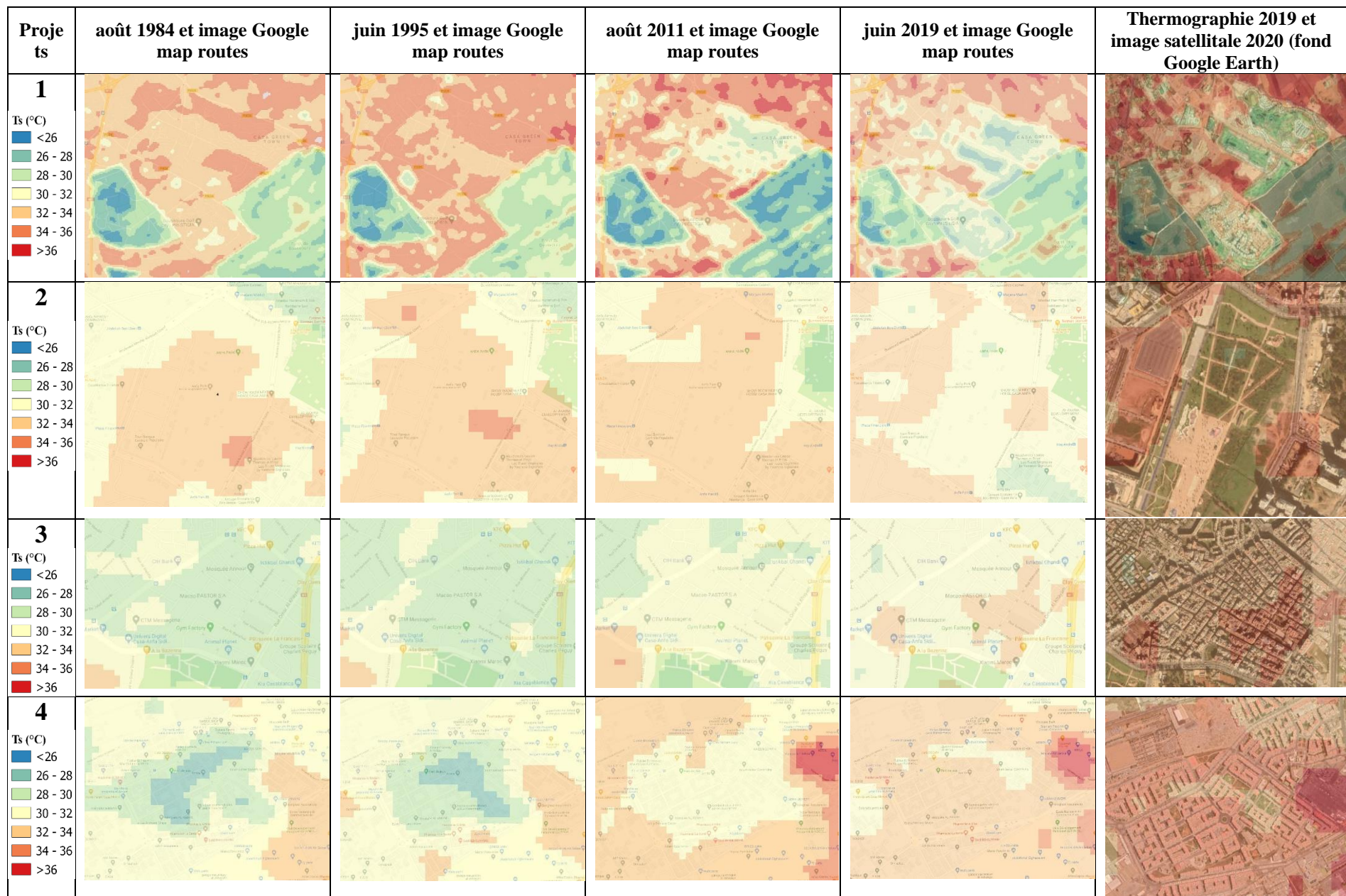
Figure 10. Evolution des températures de surface pour quatre sites du Grand Casablanca ayant subi des réaménagements lourds sur la période 1984-2019.
