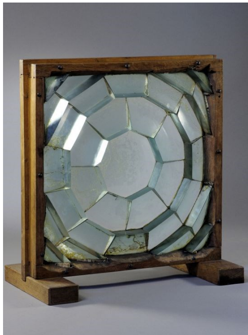
Figure 1 - Prototype de lentille à échelon présenté à la Commission des phares le 31 octobre 1820 1 (collections de l'Observatoire de Paris)
