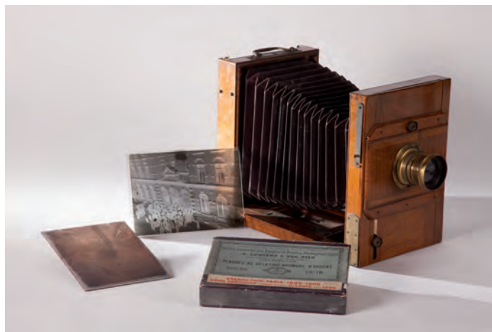
Appareil photo à soufflet et plaques de verre photographiques (début du XX e siècle) (cl. L. Kieffer – Musée de La Cour d'Or-Metz Métropole)
