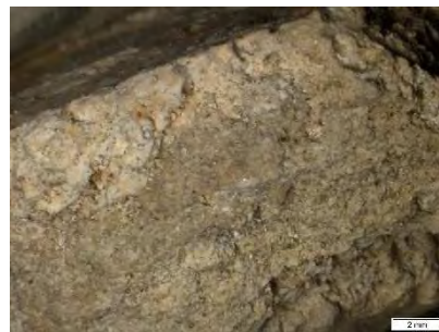
Figure 7 : Aspect macroscopique du mortier de type D, avec une couche terminale d'enduit à la chaux, d'aspect bien blanc ( la mire indique 2mm ).
