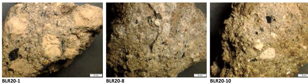
Figure 3 : Divers aspects macroscopiques des mortiers de type A ( la mire indique 2mm )
