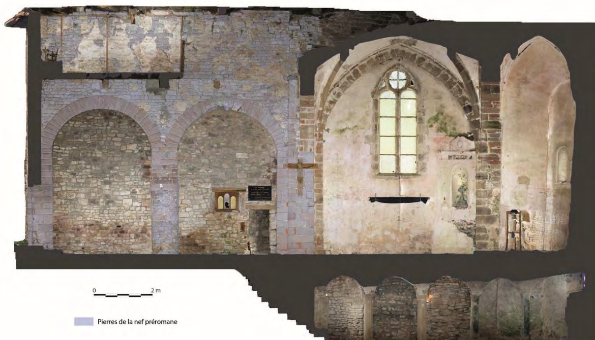
Fig.18 – Photogrammétrie intérieure nord et mise en évidence de la nef. (acquisition © R. Janvier ; DAO © L. Suss)
