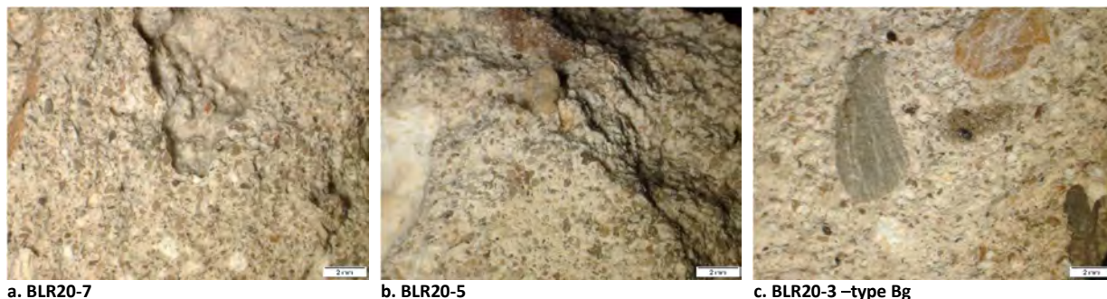
Figure 4 : Divers aspects macroscopiques des mortiers de type B et B g (la mire indique 2mm).
