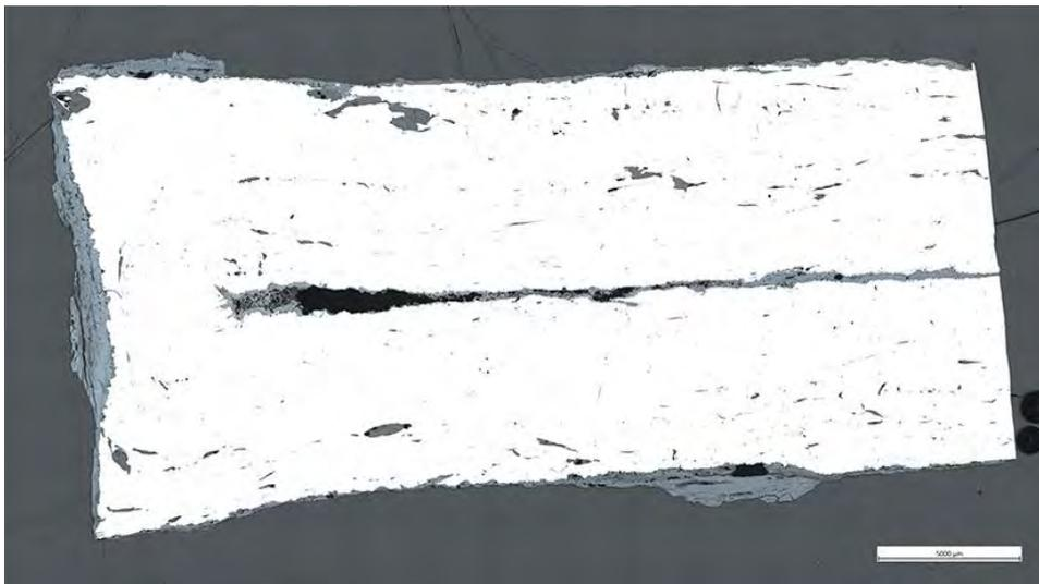
Fig. 7 : Couverture micrographique complète de la section polie de StMaur 7274 avant attaque métallographique
