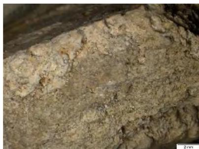
Les échantillons prélevés dans la **nef de l'église et en extérieur** (BLR20-11, 12, 13 et 14) sont très proches des mortiers de type B, échantillonnés dans la crypte. Visuellement la distribution granulométrique semble être cependant légèrement différente mais cette hypothèse n'a pu être clairement démontrée. Des analyses granulométriques ultérieures sont envisagées. Ils ne contiennent aucun fragment de charbon et les nodules de chaux, relativement peu abondants, sont de taille assez limitée.
