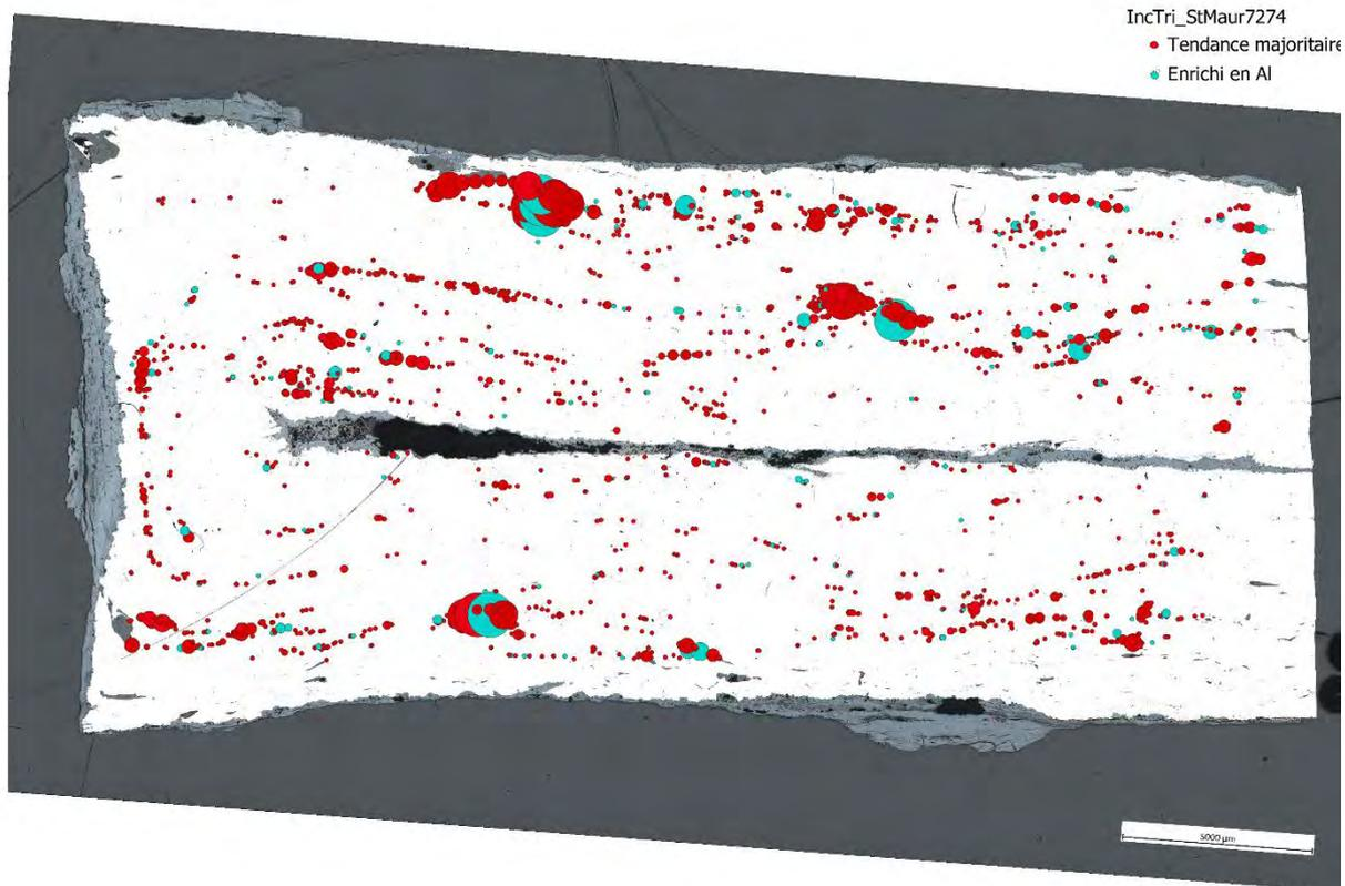
Fig. 16 : Répartition des classes d'inclusions chimiques interprétées – StMaur 7274
