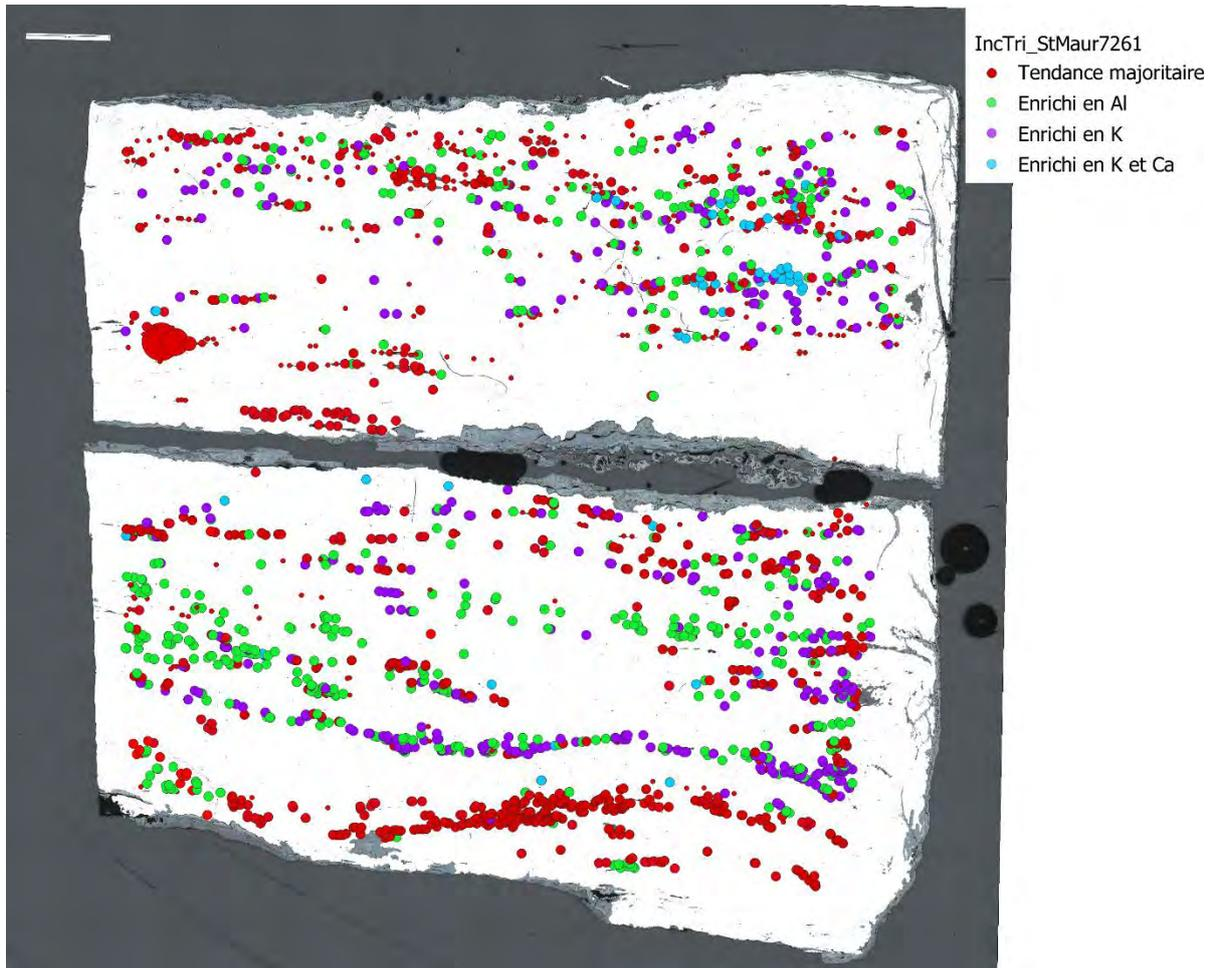
Fig. 13 : Répartition des classes d'inclusions chimiques interprétées – StMaur 7261
