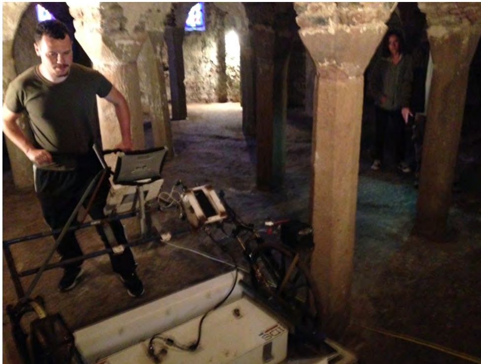
Figure 3: Le GPR en acquisition dans la crypte de Bleurville
