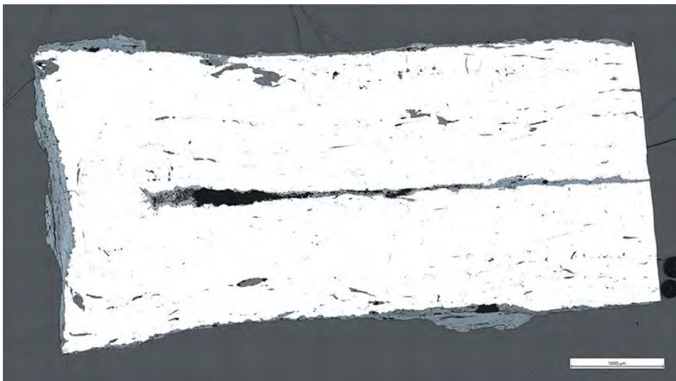
Fig. 7 : Couverture micrographique complète de la section polie de StMaur 7274 avant attaque métallographique
