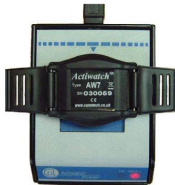
Figure 29 : Actimètre utilisé pour la mesure de l'activité sur le dispositif permettant l'extraction des données
