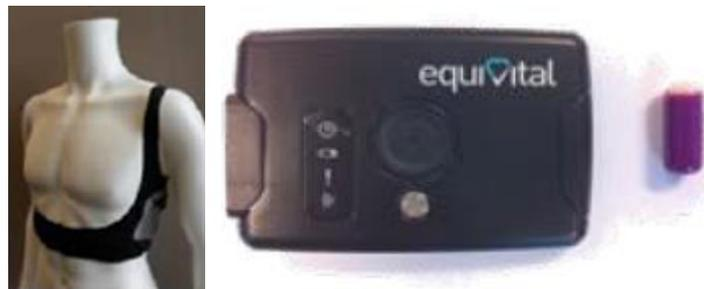
**Figure 27 : Ceinture, enregistreur et pilule téléométrique utilisés pour les mesures de la température corporelle interne et du rythme cardiaque**
