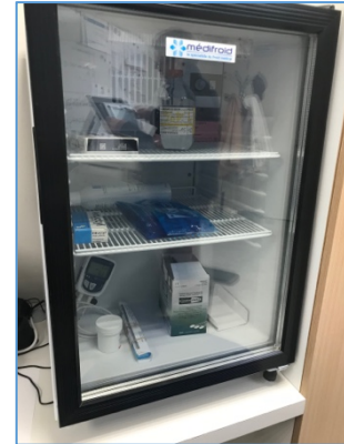
Figure 11 : Enceinte réfrigérée du secteur Jardin d'Alois et sa sonde enregistreuse mesurant la température interne en temps réel.
