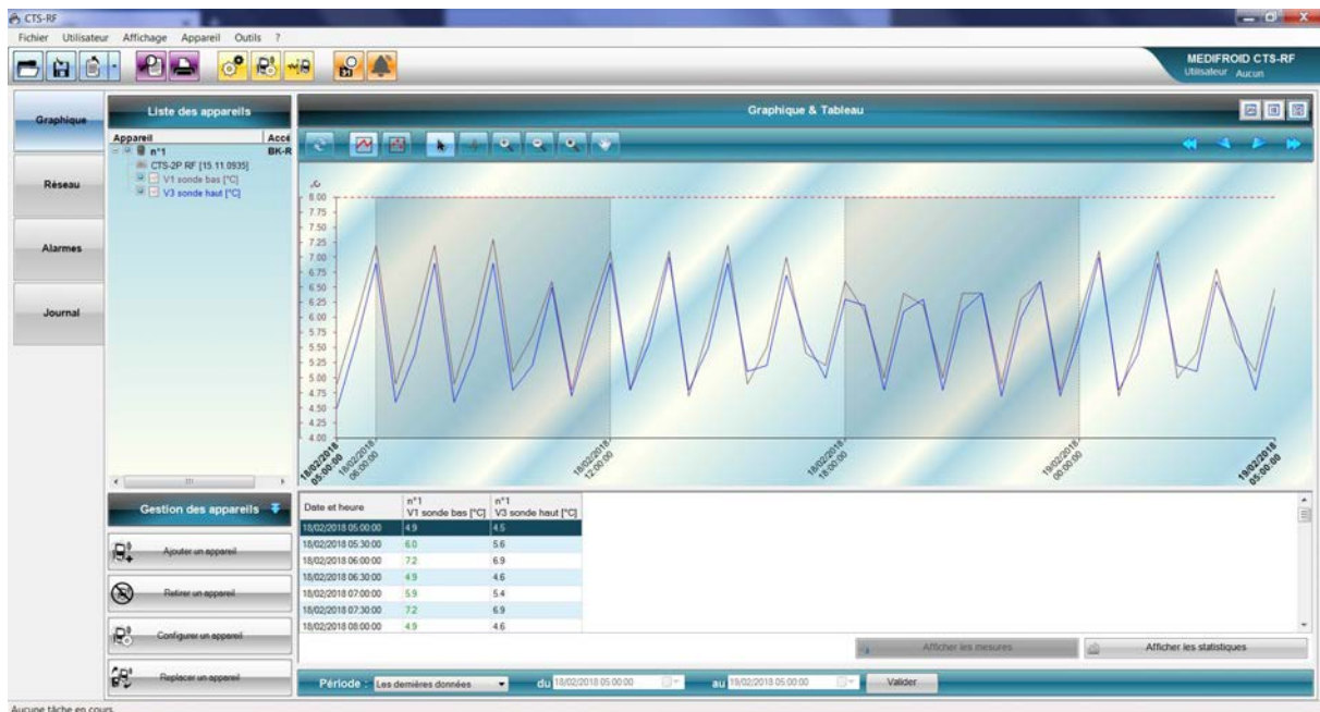
Figure 10 : Logiciel de récupération des données enregistrées par la sonde placée dans l'enceinte réfrigérée.
