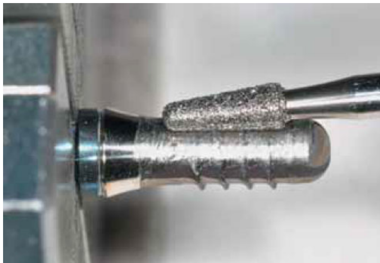
Figure 33 : Implantoplastie par fraise diamantée dans un modèle expérimental (source : Meier, 2012)
