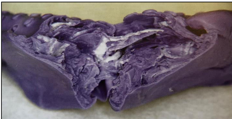
Figure 22 : Déchirure d’un silicone mal malaxé montrant un manque d’homogénéité : les qualités physico-chimiques sont diminuées. (Source : Descamp)
