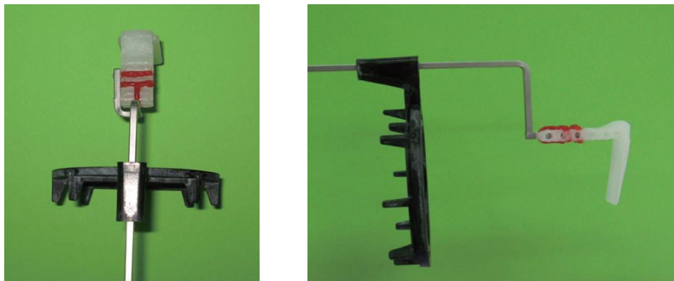
Figure 42 : Angulateur en vue de dessus et vue latérale (source Tavakolizadeh et al. 2015)
