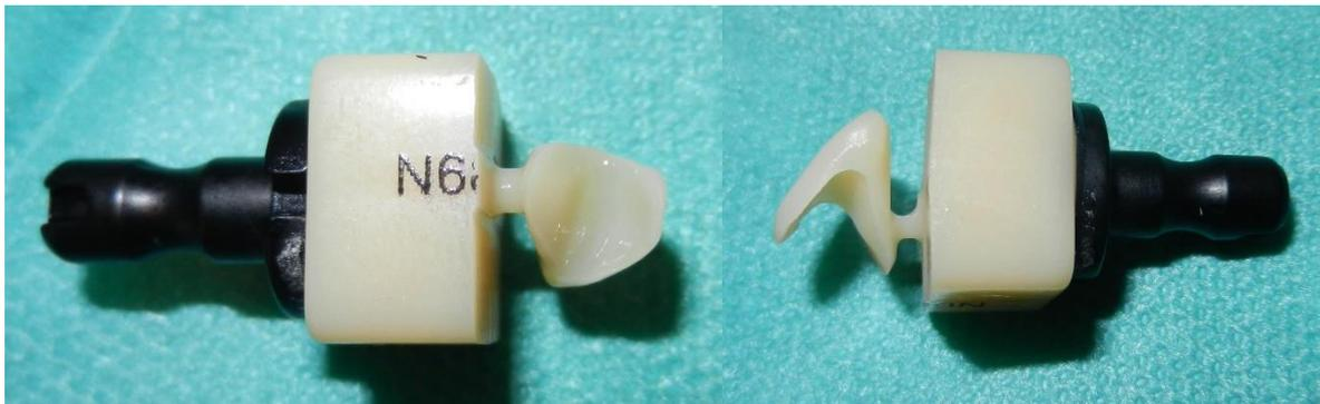
*Figure 55 : Facette usinée, encore attachée à son bloc (source : P. Corne).*
