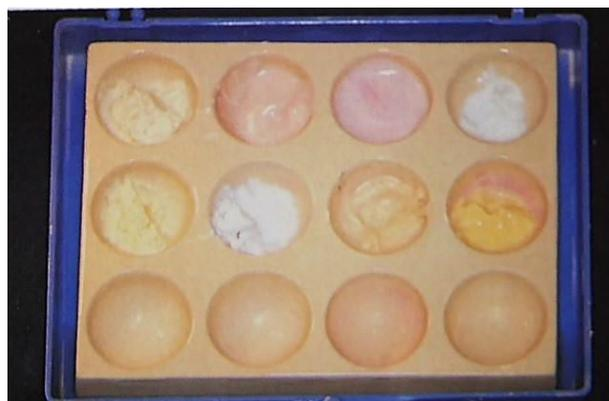
Figure 37 : boîte à humidification constante (source : Ubassy, 1992)
