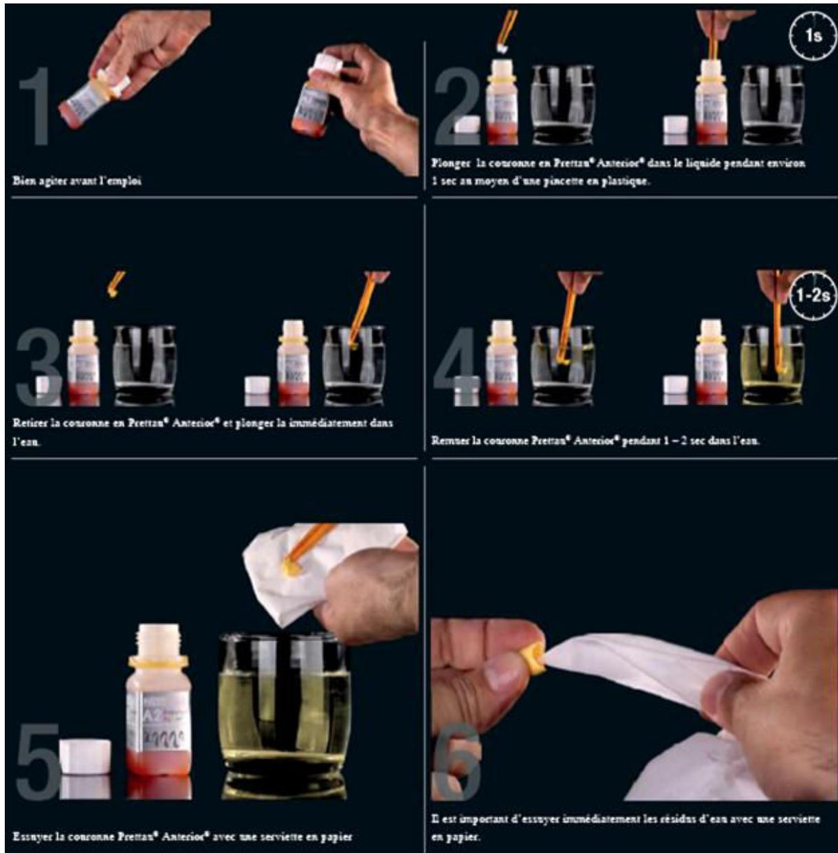
Figure 74 : instruction pour la coloration de la zircone par trempage (d'après : Zirkonzahn)
