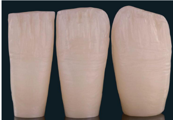
Figure 135 : zircone Prettau® après création de la microstructure de surface, coloration et frittage (source : Zirkonzahn, 2015)
