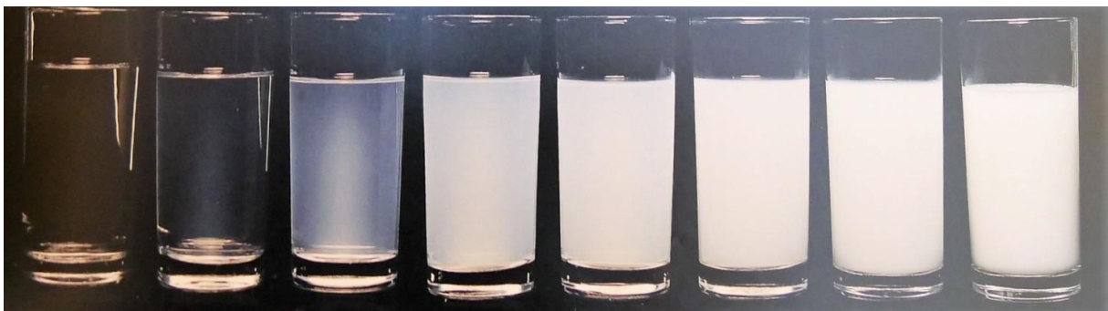
Figure 11 : devant un fond noir la luminosité diminue quand la translucidité du liquide augmente (source : Kina et coll, 2008)
