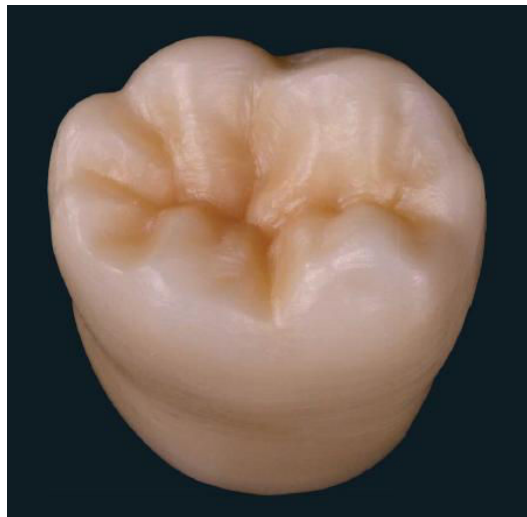
Figure 133 : structure en zircone colorée, après frittage mais avant maquillage (source : Zirkonzahn, 2015)
