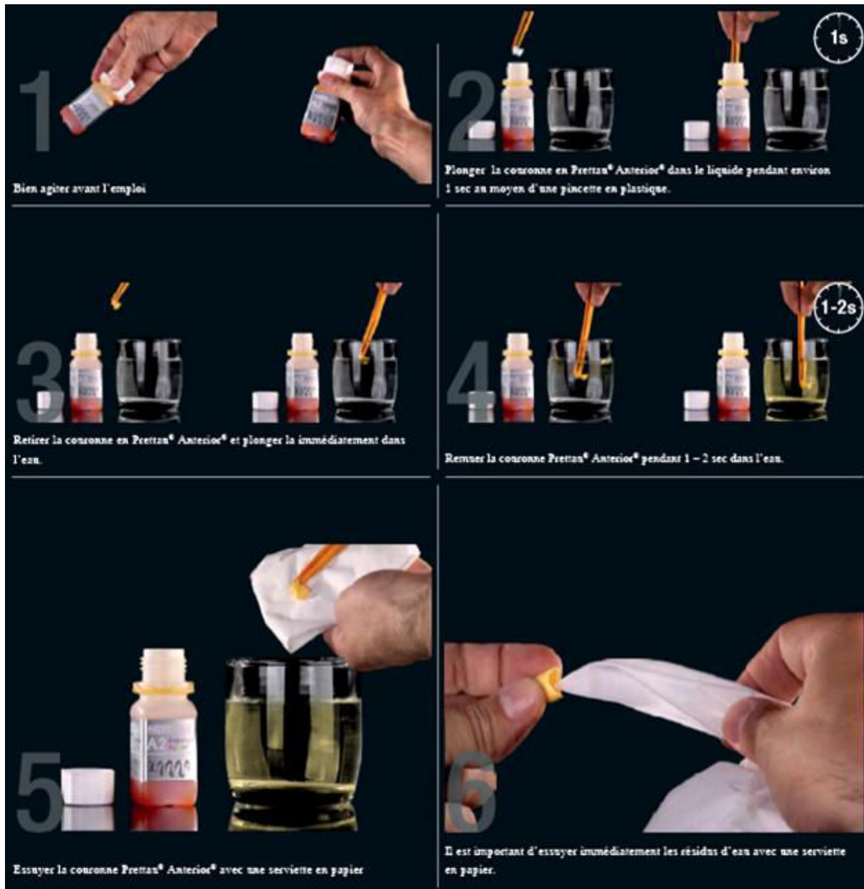
Figure 74 : instruction pour la coloration de la zircone par trempage (d'après : Zirkonzahn)
