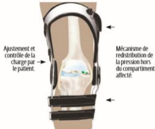
Figure 82 : Le système 3 points de décharge (94)
