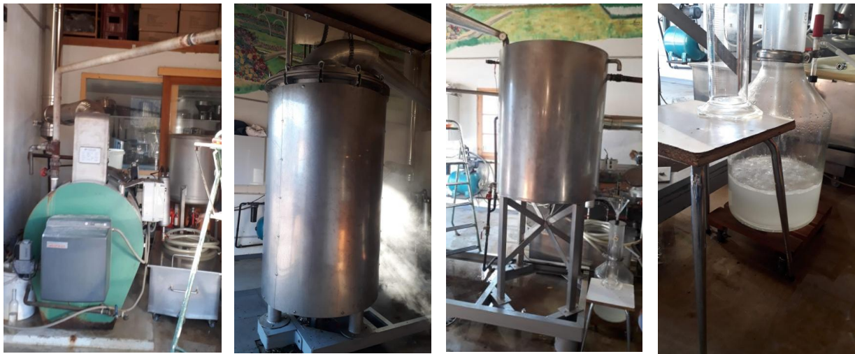
Figure 7 : Les différentes parties de l'alambic en inox de la Ferme du Bien-être : la chaudière, la cuve contenant le broyat, le condenseur et le vase florentin.
