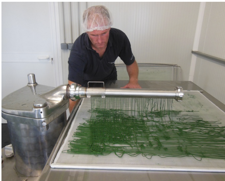
Illustration 6 : Étape de l'extrudage, photographie de Spirul'In Vosges
