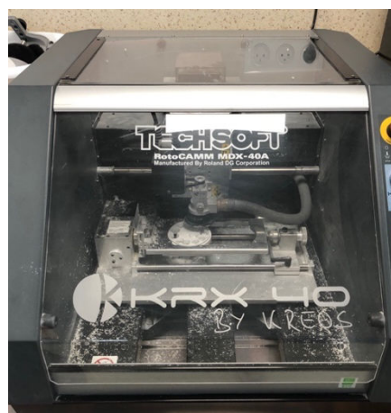
Figure 49 : Fraiseuse pour l'usinage des pièces prothétiques (source : document personnel)
