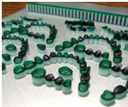
Figure 50 : Cupules en résine issues de l'impression 3D (source : UNPPD et CNIF, 2009)
